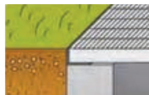
Uden fals - rist til betonkant.
