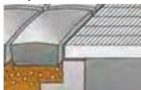
Yderfals til direkte tilslutning til belægningssten.
